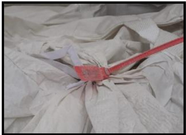
Colocación de precintos en big bag y Hoover (IBC)
