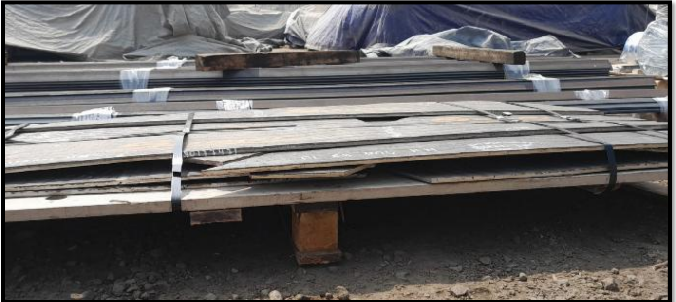
Materiales metálicos pesados apilados sin separaciones.
